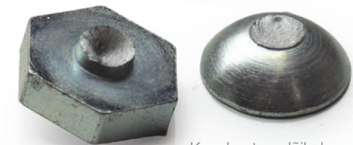
Kuuskantpea lõikub teatud pöördemomendi juures ära, jättes sileda püsipinna
