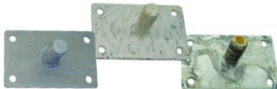
ZiNiP pärast 1500 tundi Kuumtsingitud 55 µm pärast 408 tundi Galvaaniliselt tsingitud pärast 240 tundi
